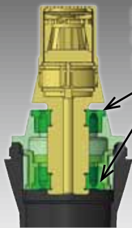
カプセルとショックマウントの断面図
