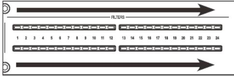
③ CHANNEL ONE と CHANNEL TWO の MODE スイッチが、黄色に点灯します。また、FILTERS LED の点灯している数が、現在有効になっているフィルターの総数を表しています。
