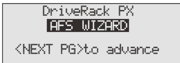
① AFS ウィザードは [AFS] スイッチを長押し、もしくはオート EQ ウィザード終了時に [NEXT PG] スイッチを押して呼び出します。ディスプレイは左図のように表示されます。[NEXT PG] スイッチを押して次のページに移動してください。
