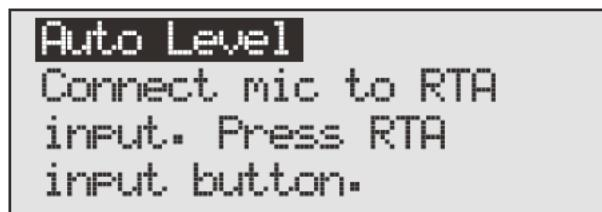
⑧オートレベルの設定を行います。オートレベルは RTA マイクロホンからの信号レベルを検出し、メインスピーカー、サブウーファーのバランスを解析する機能です。左図が表示されたら付属の RTA マイクロホン M2 を前面パネルの RTA マイクロホン入力端子に接続し、RTA マイクロホンを会場内、観客席の極力中央に配置した後、RTA 入力スイッチを押してください。
