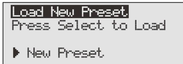
⑦設定したプログラムを新しいプリセットとして読み込むかどうかの選択です。設定を中止し、やり直す場合は [PRESET] スイッチを押してウィザードを終了してください。このまま設定を続ける場合はホイールつまみを押して読み込みを行ってください。
