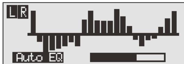
①オート EQ ウィザードは [EQ] スイッチを長押し、もしくはセットアップウィザード終了時に [NEXT PG] スイッチを押して呼び出します。ディスプレイは左図のように表示されます。[NEXT PG] スイッチを押して次のページに移動してください。
