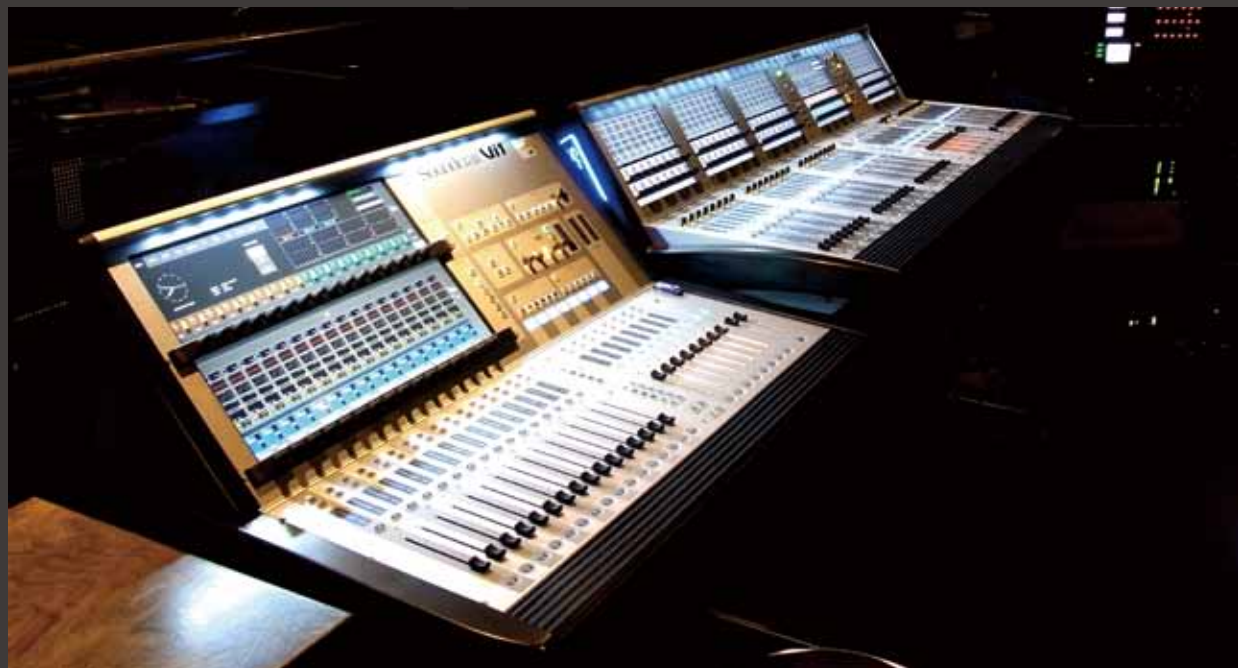
▲ O-EAST のハウス調整卓、Vi1 (手前) と Vi6 (奥)。デジタル・ミキサーを導入したことにより、転換時のオペレーター作業負担を大幅に軽減できたとのことで、運用効果についてご満足いただいています。
