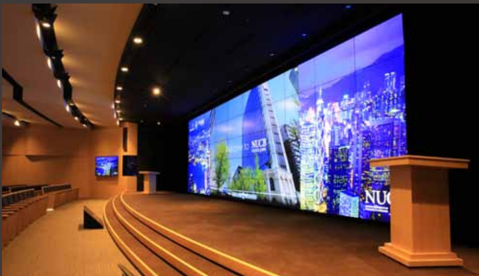
▲ 大ホール (14F)・・・50 台のモニターで構成するマルチディスプレイシステムを設置。
