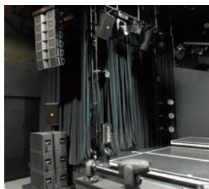
↑ 舞台袖のメインスピーカーシステムとアンブラックラインアレイはJBL PRO「VT4886」と「4883」、インフィルには「SRX712M」。ラックにはAMCRONのアンプとBSSのプロセッサーを搭載。
