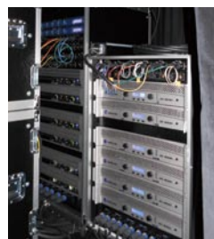
↑ 舞台袖のメインスピーカーシステムとアンブラックラインアレイはJBL PRO「VT4886」と「4883」、インフィルには「SRX712M」。ラックにはAMCRONのアンプとBSSのプロセッサーを搭載。
