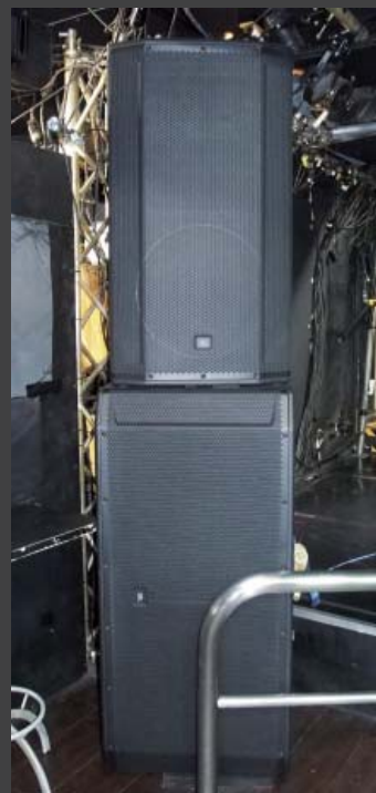
▲「SRX828P Powered」に「SRX835SP Powered」を積み上げることで、わずかなスペースに収められている。
