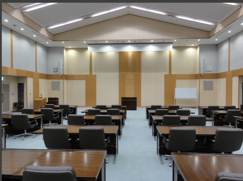
▲室内全景 前方の壁面に CBT 70J-1 と CBT 70JE-1 (拡張用スピーカー) を連結して設置。「426㎡の室内を、1 対のスピーカーでカバーします。明瞭な音質を、最前列から最後列まで均一に提供できます。最大音圧にも余裕があります。」とのこと。
