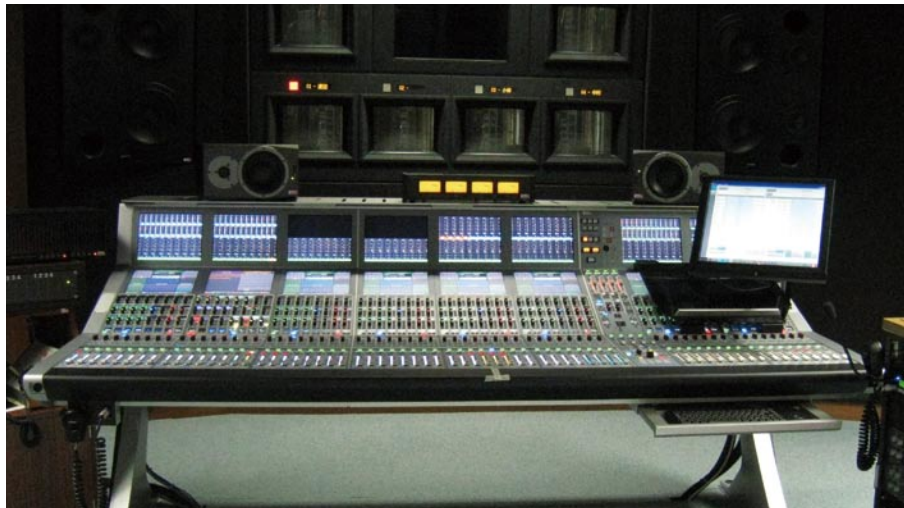
▲調整室に設置された収録用のメインコンソール CALREC “APOLLO”
