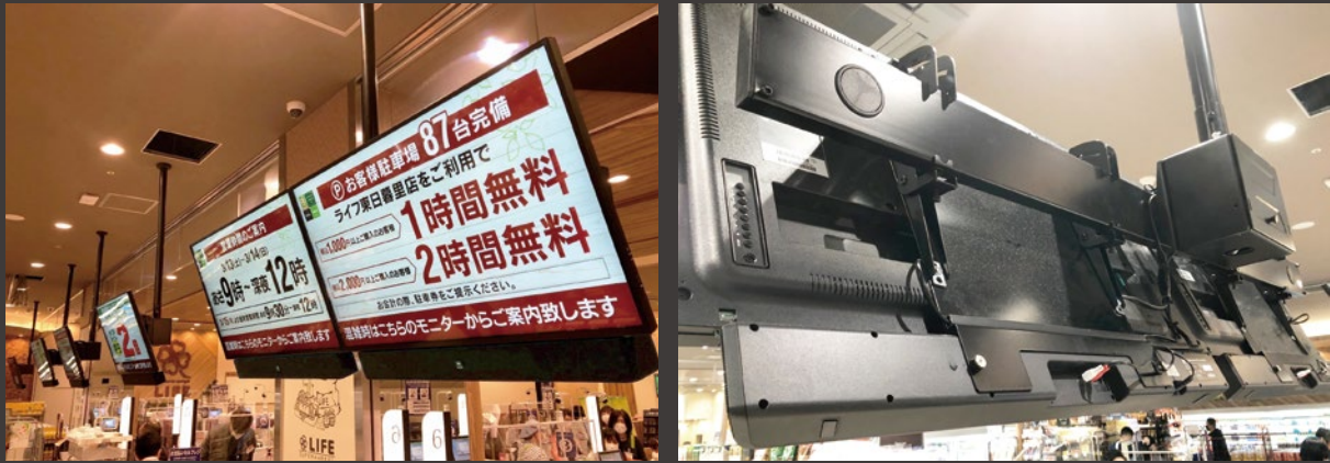
▲レジ上に取り付けられたモニターの下に「PSB-1」が設置されている。ヒビノスペーステックのオリジナル金具で違和感なく自然に設置された。
